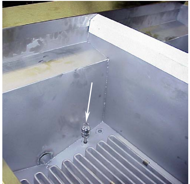
Emplacement de l'interrupteur de sécurité à flotteur.
