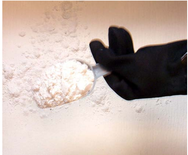
Utilisez une tasse de mesure ou une pelle pour répartir la poudre uniformément sur le papier-filtre.
