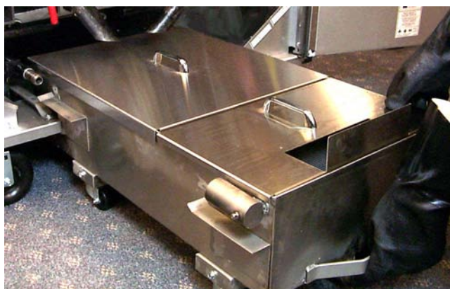
Poussez le bac du filtre pour le remettre dans l'armoire. Le filtre est prêt à fonctionner.
